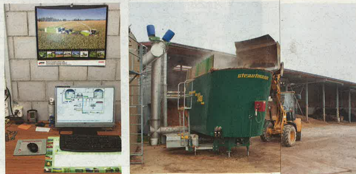
Les installations sont remplies de 80% d'engrais de ferme et de 20% de cosubstrats, des
